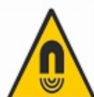
خطر حوزه آهن ربایی قوی DANGER STRONG MAGNETIC FIELD
