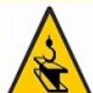
خطر بارهای آویزان Warning overhead loads
